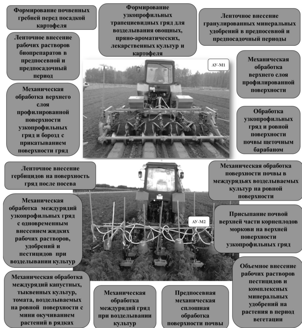
Рисунок 5 – Виды технологических операций, выполняемых агрегатом АУ-М в трех модификациях
